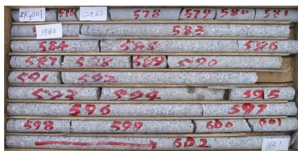
(a) 广东阳江抽水蓄能电站高压隧洞区钻孔岩芯(ZKy001)
